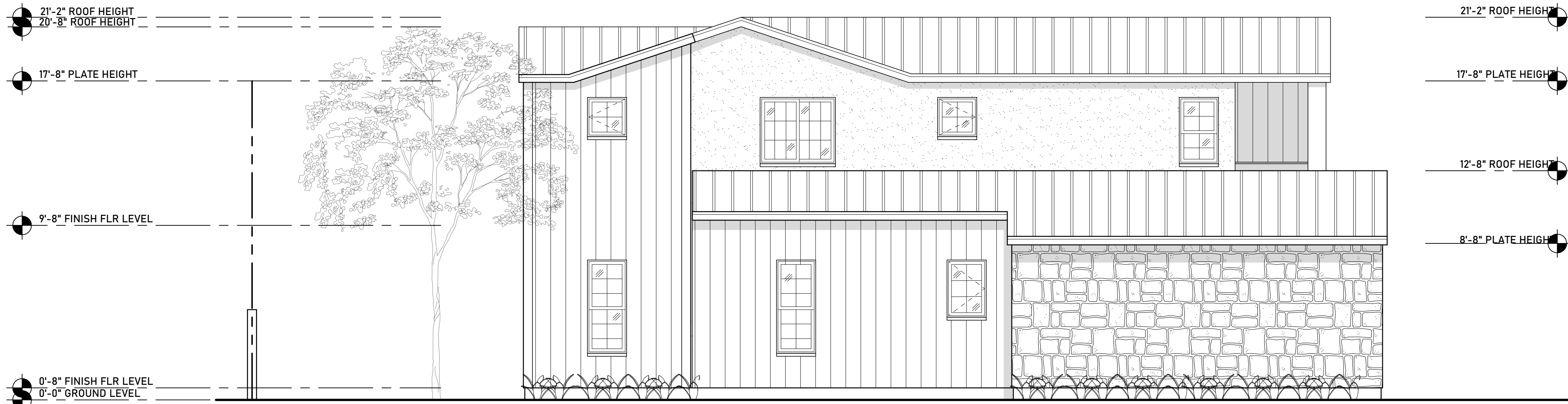
ELEVATION - DD SCALE: 1/4" = 1'-0"
